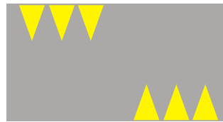
Z 6b Stavebný spomaľovací prah (označenie)
